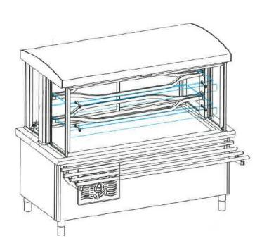
entre niveau de l'air. Ensemble de portes monté sur rail alu et galets. Fermeture avant par rideau thermique micro aéré. Rideau fixé dans capot inox en pans cassés, servant également de déflecteur pour l'éclairage led. Capot soutenu à l'arrière par 2 poteaux inox 120x40. À l'intérieur, 3 niveaux de glace sécurit ep10 mm, largeur 430 mm, montés sur consoles inox réglables en hauteur.
